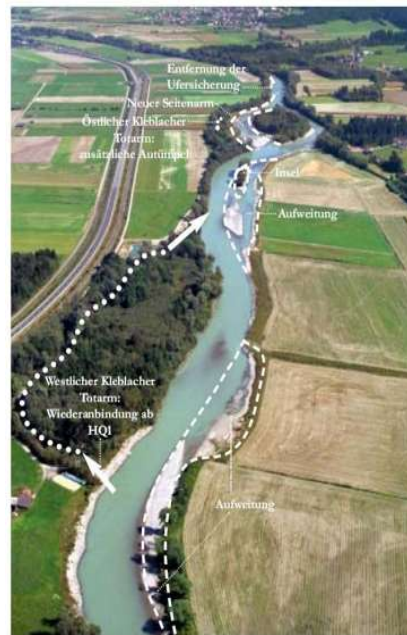
Figura 13 - Nella Drava (Austria), a causa del confinamento tra difese spondali in massi, l'alveo ha subito una progressiva incisione che, scalzando le difese stesse, comportava continui costi di manutenzione, non sostenibili a lungo termine. Sono state così gradualmente smantellate le difese spondali e ampliato l'alveo, in modo da rallentare la corrente e indurre la sedimentazione, contrastando così l'incisione.
