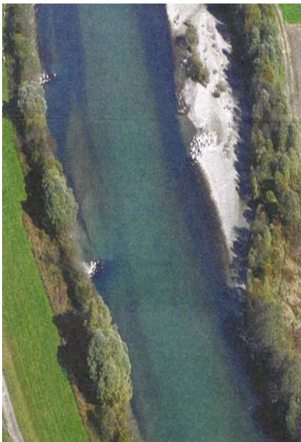
Figura 13 - Nella Drava (Austria), a causa del confinamento tra difese spondali in massi, l'alveo ha subito una progressiva incisione che, scalzando le difese stesse, comportava continui costi di manutenzione, non sostenibili a lungo termine. Sono state così gradualmente smantellate le difese spondali e ampliato l'alveo, in modo da rallentare la corrente e indurre la sedimentazione, contrastando così l'incisione.
