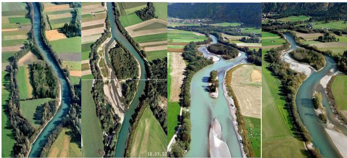
Figura 18 - Creazione di un canale secondario nel fiume Drava in Austria
