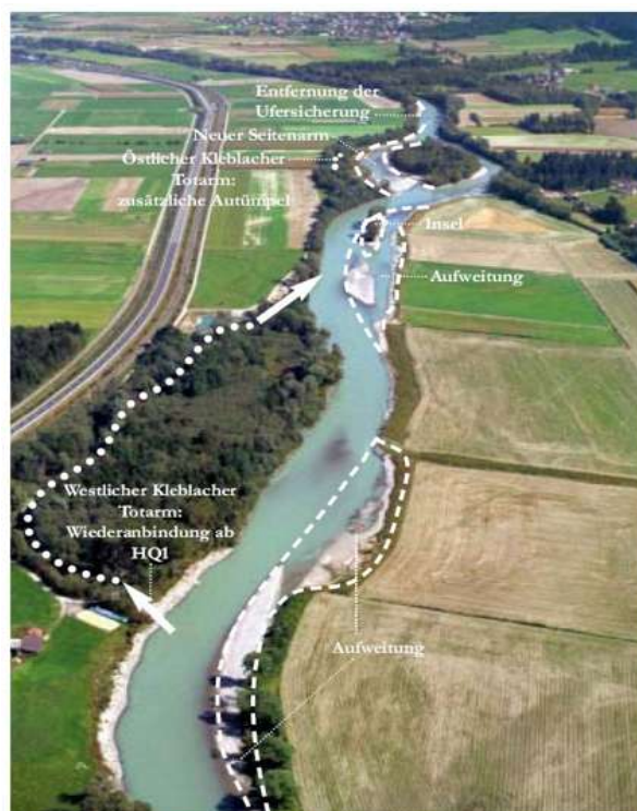
Figura 19 – Diversificazione morfologica delle aree limitrofe al corso d'acqua. Fiume Drava (Austria)
