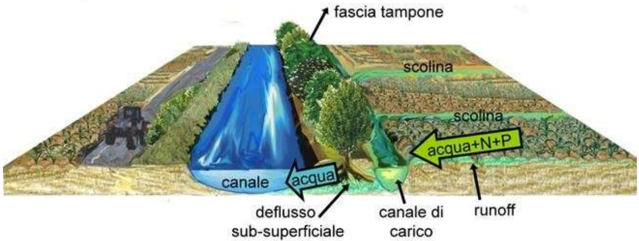
Figura 29 – Schema progettuale di una FT per il trattamento dei carichi di N veicolati tramite deflusso sub-superficiale (fonte: G. Conte, M. Monaci, B. Boz, D. Lenzi)
